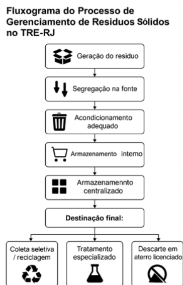
Figura 1 – Fluxograma Geral do Processo de Gerenciamento de Resíduos Sólidos no TRE – RJ.
